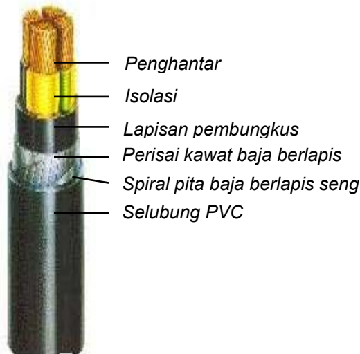
Gambar 2.31 Kabel N2XY
