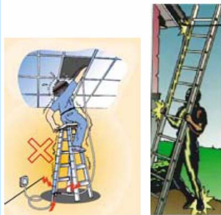
Gambar 1.18 Penggunaan tangga di daerah instalasi listrik
